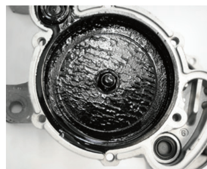
Fig. 3: La morchia nella pompa per vuoto di un VW Transporter produce un picchiettò
